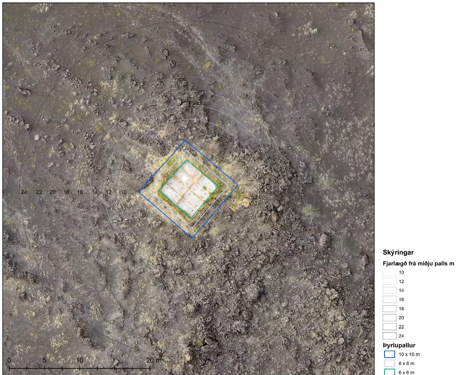
Mynd 4. Loftljósmynd af þyrlupalli frá árinu 2023. Útlínur stækkunar eru einnig sýndar sem og fjarlægð frá miðju pallsins.
